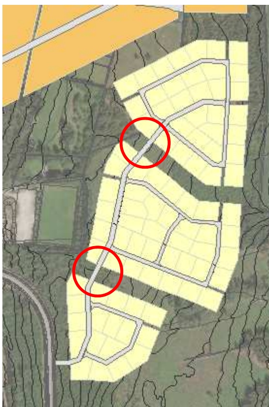
Figur 10. De markerade sträckorna behöver ha välfungerande vägtrummor för att säkerställa att vatten inte rinner upp på vägen.
