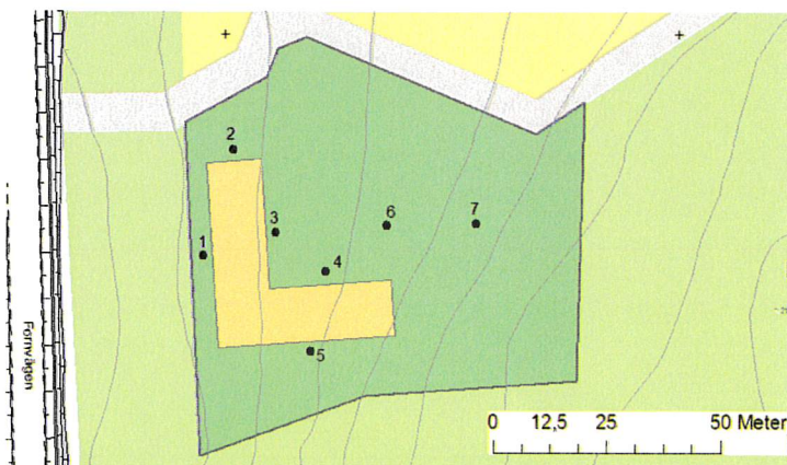
Punkter där beräkning av ljudnivån har genomförts och förslag på byggnadsutformning för att skapa en större utemiljö där 50 dBA ekvivalent ljudnivå inte överskrids.
